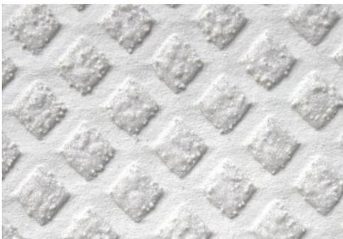
Laminato elastoplastico autoadesivo rivestito in resina poliuretanicca, con elementi a rilievo contenenti microsfere in ceramica ad altissima rifrangenza ed antiscivolo
